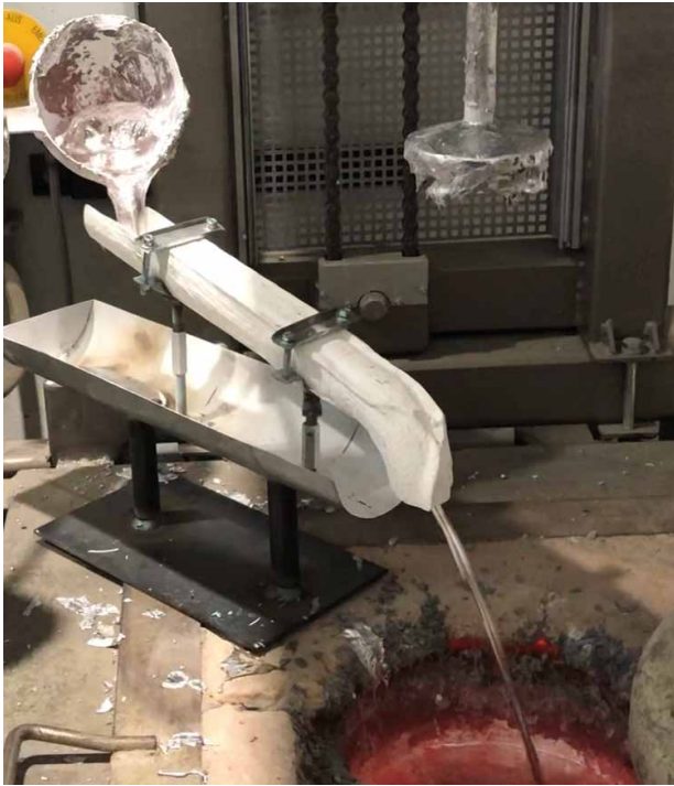
Bild 4: Charakterisierung einer OFC-Gießrinne an der TU Bergakademie Freiberg.
