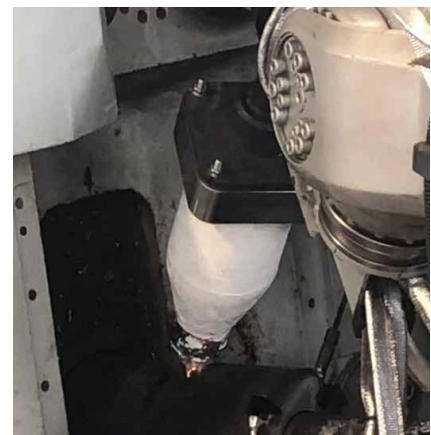
Bild 1: OFC-Bauteil im Einsatz an einer Kaltkammer-Druckgießmaschine der Hochschule Aalen.
